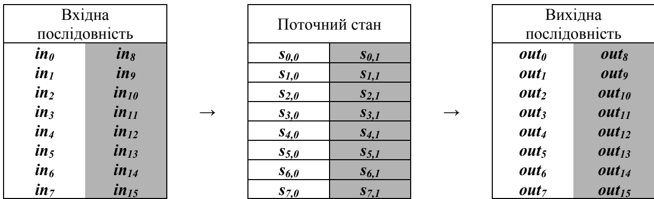
Рис. 1 – Заповнення поточного стану для довжини блока 128 біт
